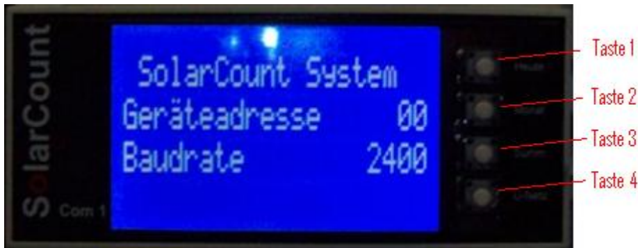
Abb. 3 Einstellen der Baudrate und Geräteadress
